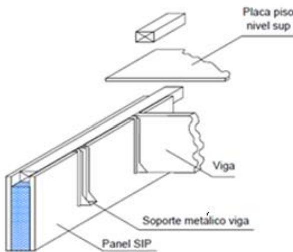
Detalle llegada viga solución "A"
